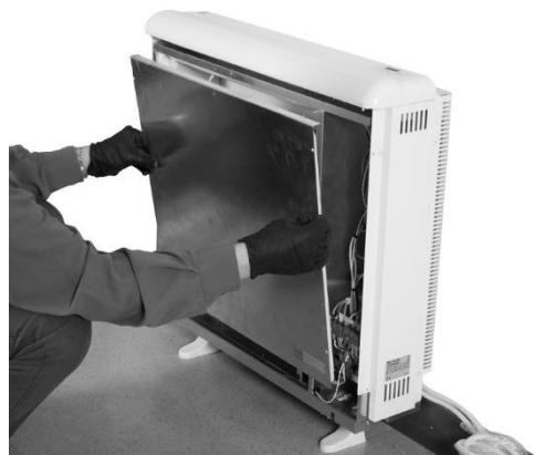
9.- No desconecte las resistencias eléctricas del aparato. Retire las protecciones de cartón y la placa metálica del interior del núcleo del acumulador. Levante las resistencias y vuélquelas hacia delante, con cuidado de no dañar los aislamientos. Coloque la primera fila de ladrillos cuidadosamente contra el fondo del aparato, disponiéndolos en dos pisos y con la cara lisa hacia atrás.
