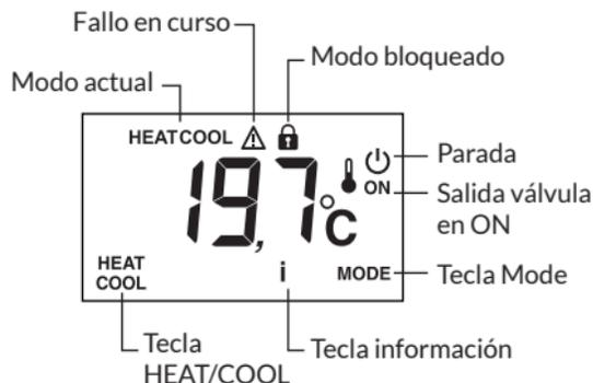
**Tecla HEAT/COOL:** aparece en modo OFF, si el termostato es de tipo «Master» y según la configuración de la instalación. Pulse durante 3 segundos la tecla para cambiar de un modo a otro.
